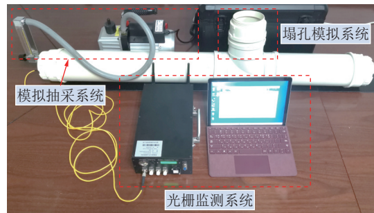
图5 试验平台系统实物
