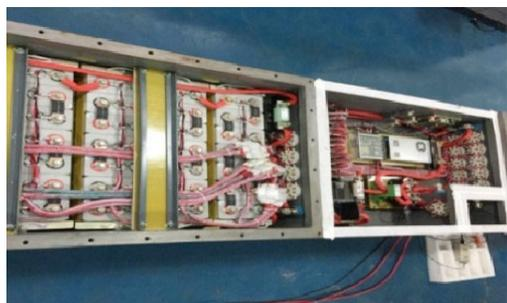
图4 典型防爆锂离子蓄电池电源装置
