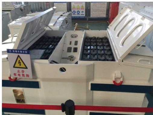
图5 典型防爆铅酸蓄电池电源装置
