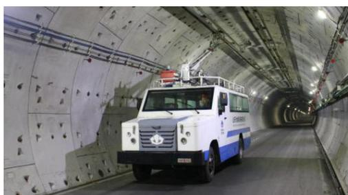
图3 典型防爆双动力架线无轨辅助运输装备
