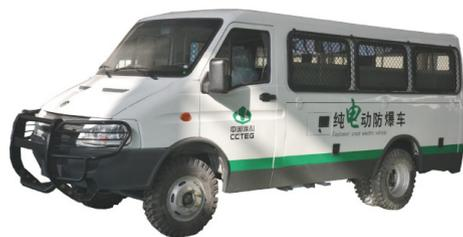
图1 典型防爆锂离子蓄电池无轨辅助运输装备
