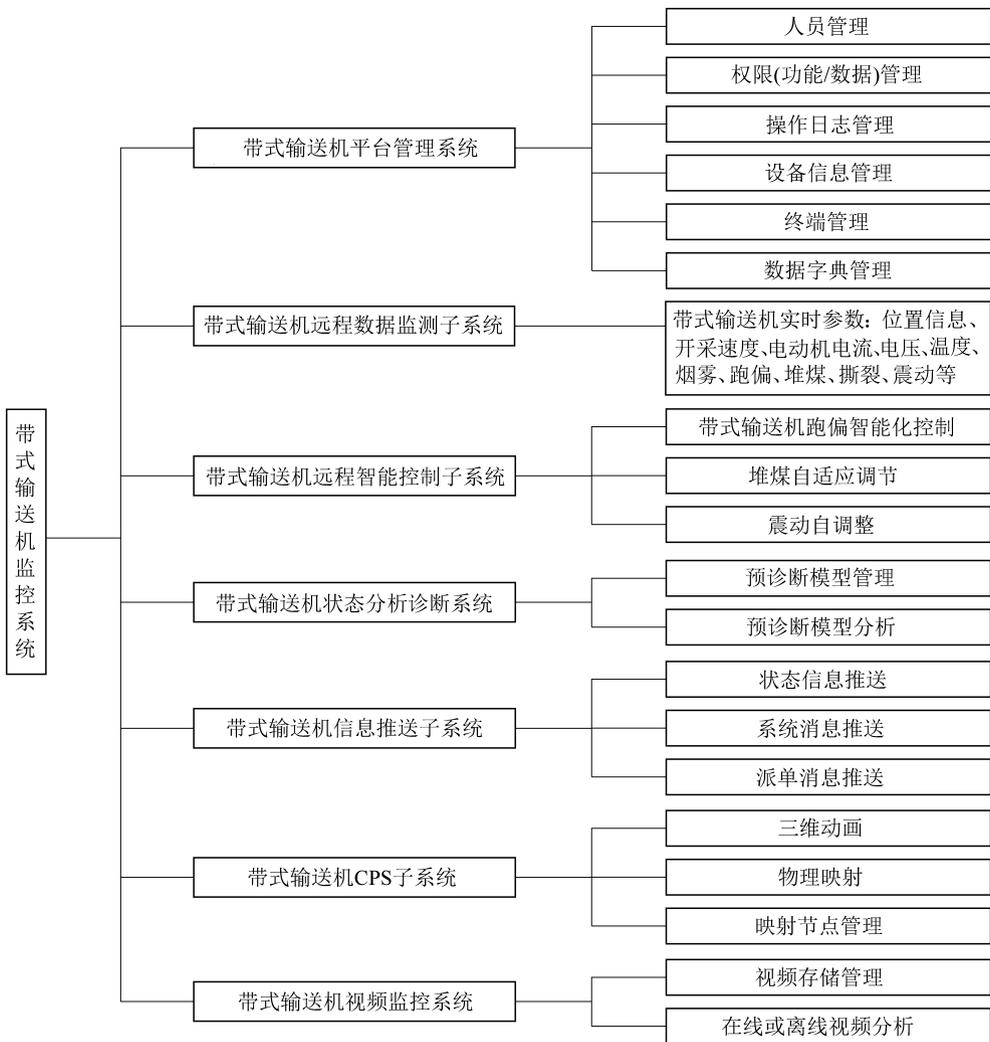
图8 煤流输送系统大数据远程监控系统应用平台功能架构
