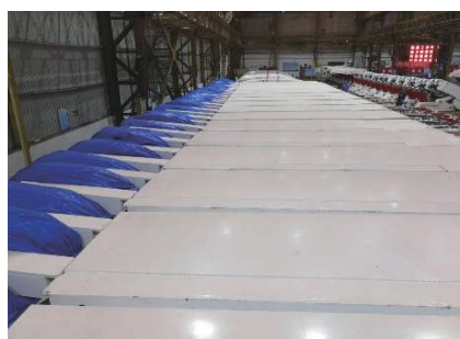
(b) 地面柔模充填袋布置试验
