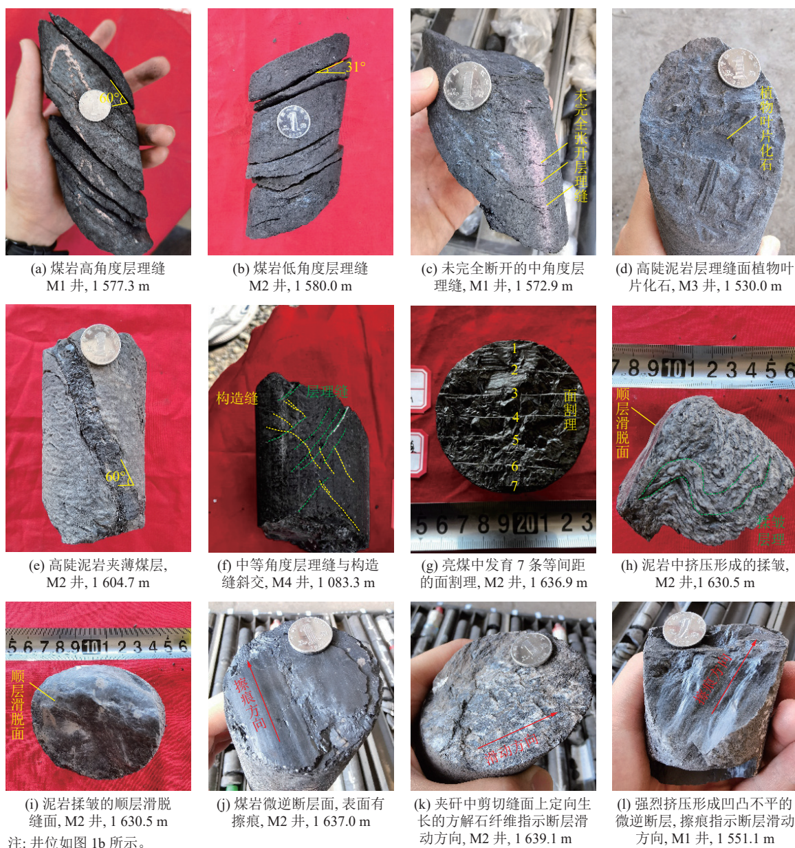
图 3 米东区块西山窑组煤系岩心天然裂缝特征
