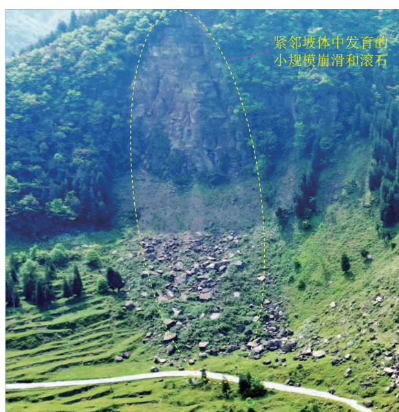
图 14 贵州张家湾普洒村煤矿日常爆破回采引起紧邻坡体形成的小规模崩塌和滚石
