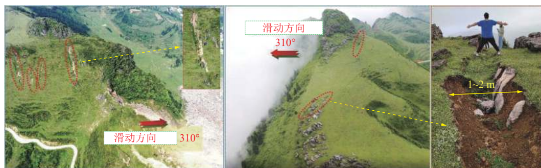
图 9 贵州张家湾普洒滑坡原始坡体中发育的岩溶深大裂隙
