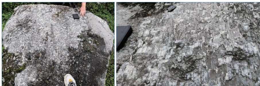
图 7 贵州张家湾普洒滑坡坡脚处岩层中存在的断层面(带)擦痕与阶步
