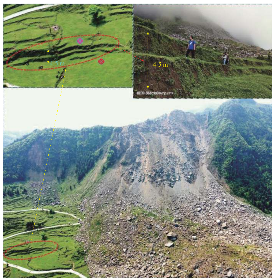
图16 原位实测的坡脚处地表阶梯形开采沉陷差值
