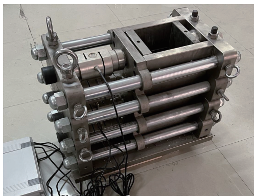
图1 组合式冒落矸石承压变形试验装置
