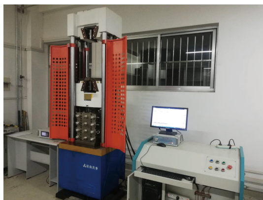
图2 冒落矸石承压变形试验系统
