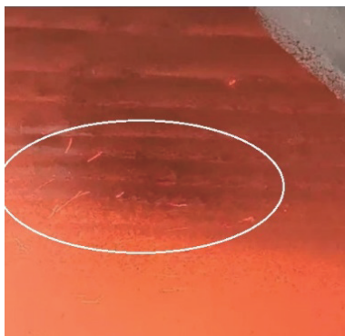
(a) D 磨煤机 R_{90}=12.0\% ；烟气温度 887\ ^\circ\text{C}
