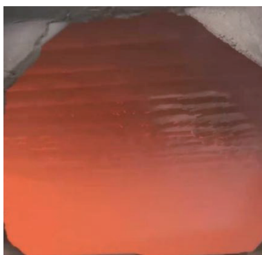
(b) D 磨煤机 R_{90}=4.9\% ；烟气温度 851\ ^\circ\text{C}
