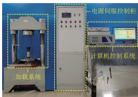
(b) 单轴压缩试验设备
