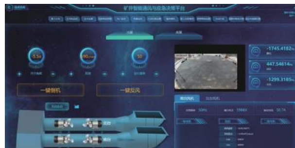
图8 通风机智能控制系统
