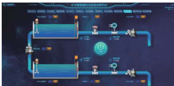
图 10 注浆防灭火控制平台
