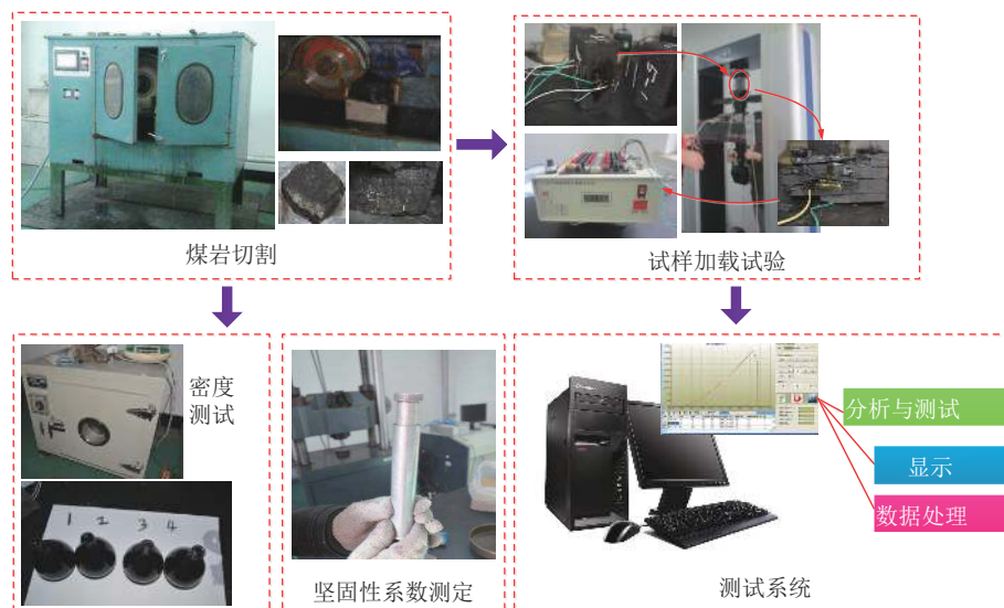
图2 煤岩物理、力学性能测试试验
