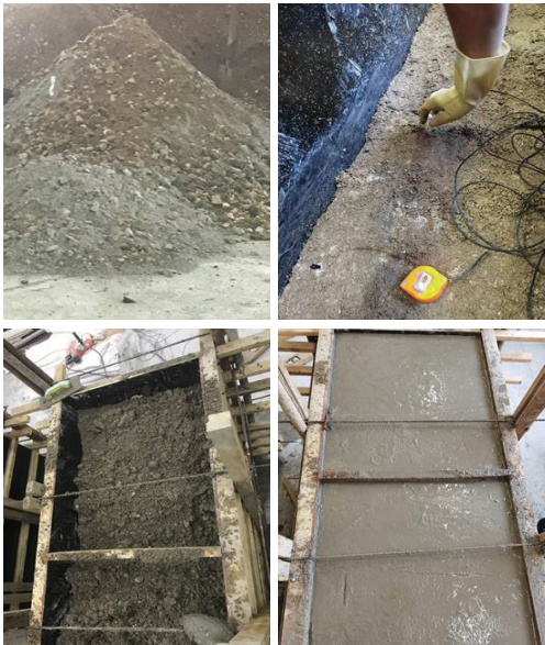
图 13 煤壁制作过程 Fig.13 Coal wall production process
