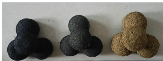
(a) 纯无烟煤型煤 (b) 秸秆生物质型煤 (c) 纯生物质成型燃料
