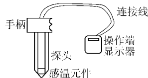
图2 热电偶测温枪的基本构造
