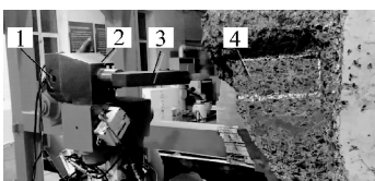
1—传感器;2—齿座;3—刀齿;4—煤壁
