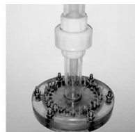
图 2 矿浆分配器喷嘴分布位置示意
