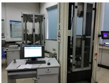
图1 WG-600 岩石单轴试验机
