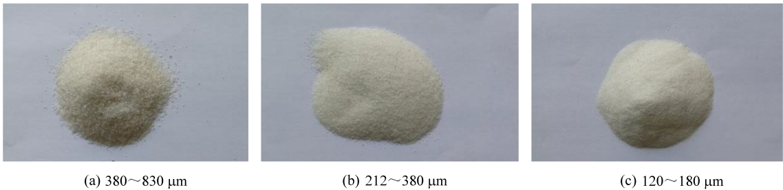
图 3 不同粒径的石英砂暂堵剂
