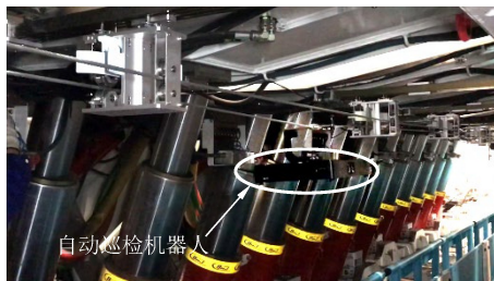
图6 自动巡检机器人现场安装
