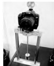
图 2 工作面快速自动安平摄影装置
