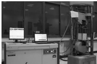
图2 拉拔试验系统
