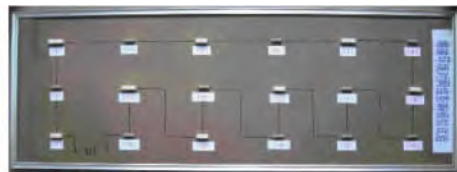
图 1 串联爆破网路模拟试验示意
