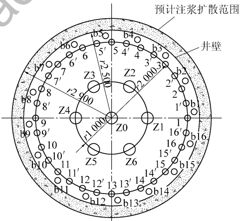
图 5 立井掘进工作面注浆孔布置
