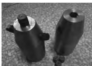
图 2 PZCK-C-* 系列水力冲孔专用喷头实物示意
